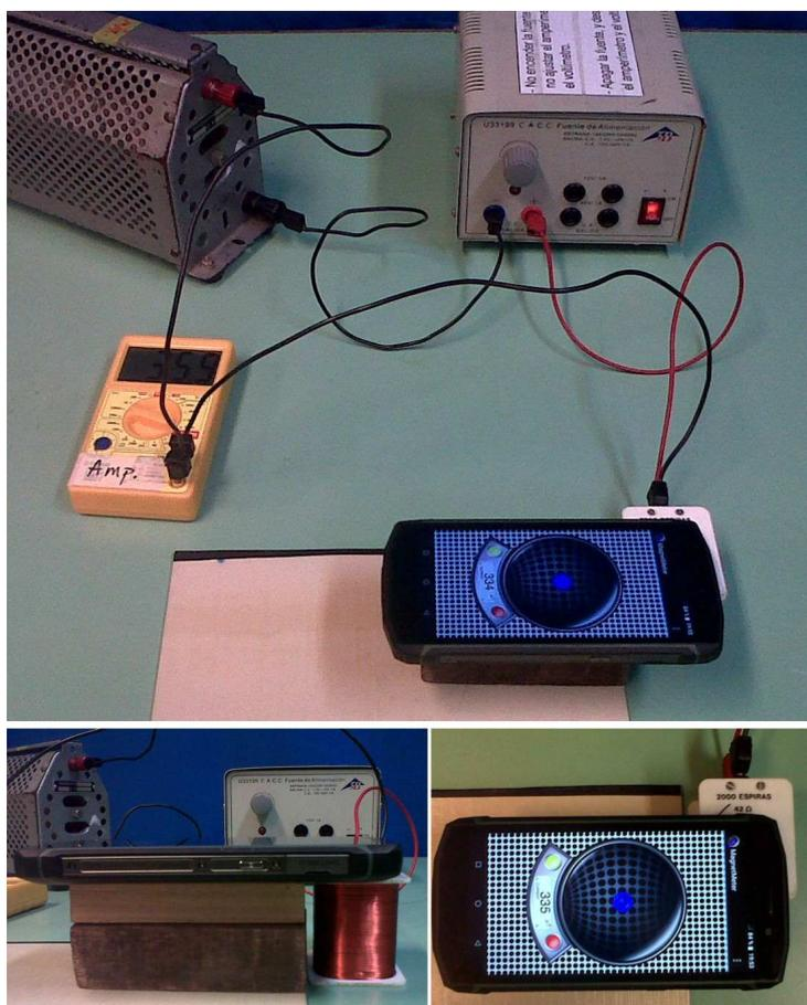
El montaje experimental consiste en una “típica” bobina de laboratorio de 2000 espiras y  $42 \Omega$ , conectada en serie a una fuente voltaje, un amperímetro, y a un reóstato.
