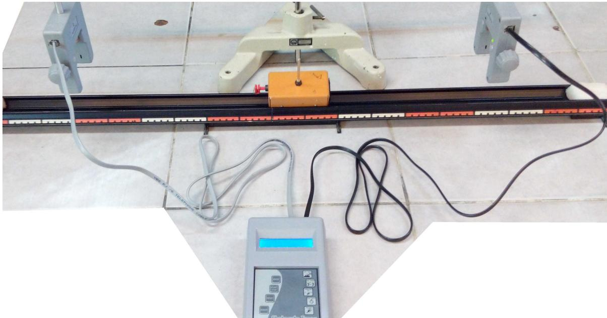
Como se observa de la foto, las barreras se conectan al contador digital (cajita “gris”, cariñosamente), que puede funcionar conectándola al toma corriente o con batería de 9 voltios. Esta última posibilidad representa otra simplificación en el montaje experimental, pero con la contra de que lamentablemente consume la batería en poco tiempo.
