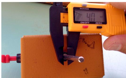
Como se puede leer en la pantalla del calibre digital, el diámetro del “fierrito” es de 4,0 mm, o sea, 0,004 m (retener este numerito).
