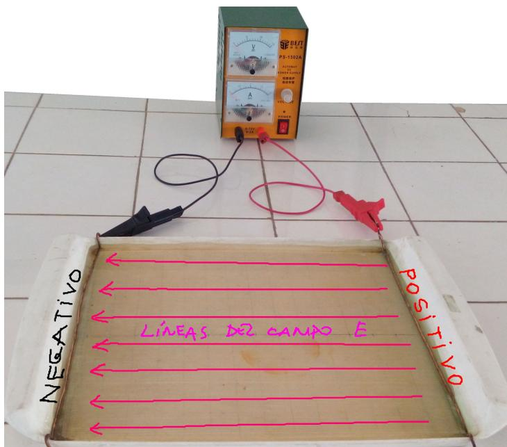
Notar que las líneas del campo electrostático uniforme son **paralelas** entre sí, y como se mencionó más arriba, salen del alambre (electrodo) cargado positivamente, y se dirigen hacia el alambre (electrodo) cargado negativamente.
